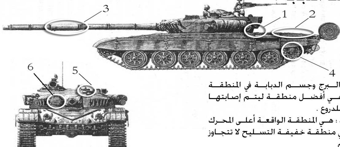
١ـالـمـنـطـقـةـ بـيـنـ الـبـرـجـ وـجـسـمـ الدـبـابـةـ فـيـ الـنـطـقـةـ الـخـالـيـةـ لـلـبـرـجـ وـهـيـ أـفـضـلـمـنـطـقـةـ لـيـتـمـ إـصـابـتـهـاـ بـالـخـشـوـاتـ الـمـضـادـلـلـدـرـوـوـ.
