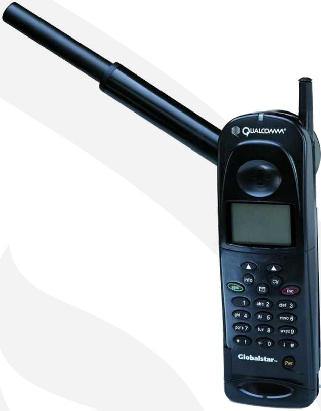
الهاتف الفضائي هو هاتف نقال يقوم بإنشاء قناة اتصال عبر أقمار صناعية ثابتة أو متحركة بالنسبة إلى الأرض عوضاً عن الشبكة العالمية للاتصالات GSM. وكون الهواتف الفضائية لا ترتبط بشبكات هاتف تخضع للدول، فهذا يسهل عمليات الاتصال في المناطق التي لا تتوفر فيها تغطية.
